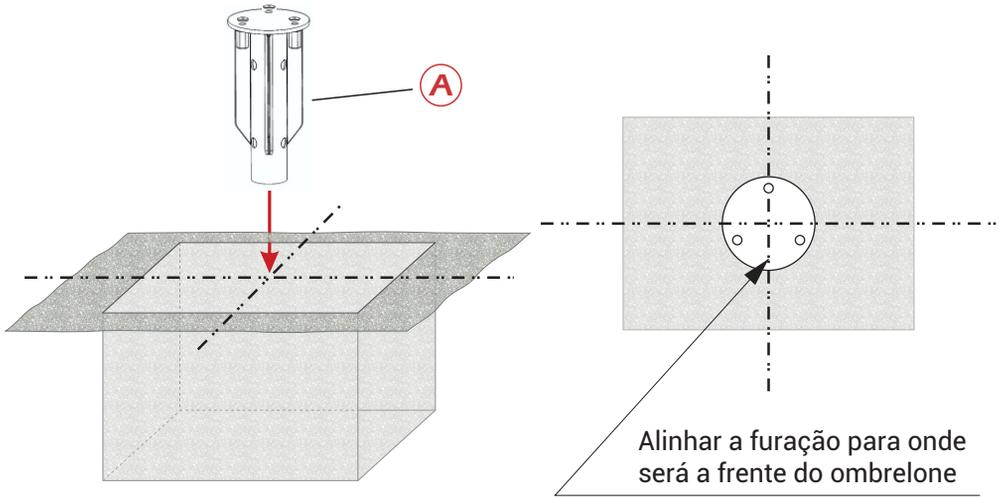
**NOTA:** Ao inserir o suporte no solo, certifique-se de que os parafusos estejam alinhados com o eixo de orientação, e parte superior do suporte esteja nivelado com a parte superior do concreto.
