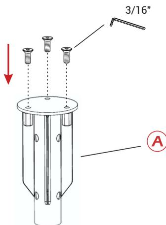
**03** Despeje o concreto e insira a *base de chumbar* (A) no centro do bloco de concreto.
