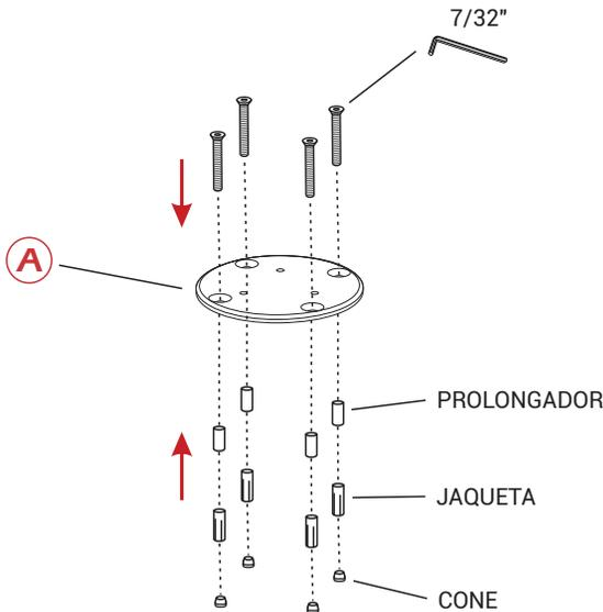
**06** Insira a ancoragem montada com a base de parafusar (A) nos orifícios. Com a Chave ALLEN 3/16" aperte todos os 4 parafusos com segurança. Em seguida aperte os 3 parafusos do sistema de fixação da Haste (B).
