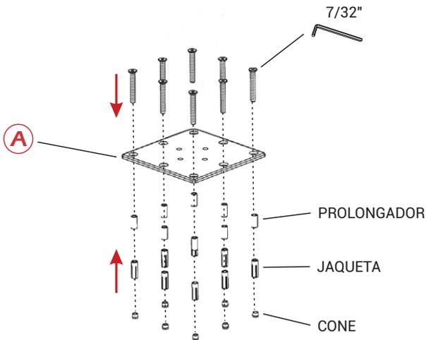
**06** Insira a ancoragem montada com a *base de parafusar* (A) nos orifícios. Com a Chave ALLEN 7/32" aperte todos os 8 parafusos com segurança. Em seguida aperte os 4 parafusos do sistema giratório (B).
