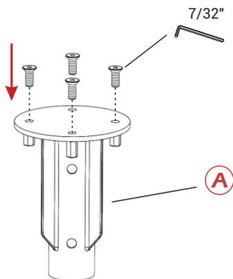
**03** Despeje o concreto e insira a *base de chumbar* (A) no centro do bloco de concreto.
