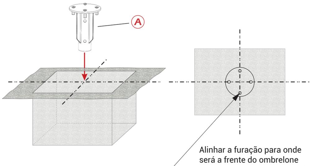
**NOTA:** Ao inserir o suporte no solo, certifique-se de que os parafusos estejam alinhados com o eixo de orientação, e parte superior do suporte esteja nivelado com a parte superior do concreto.
