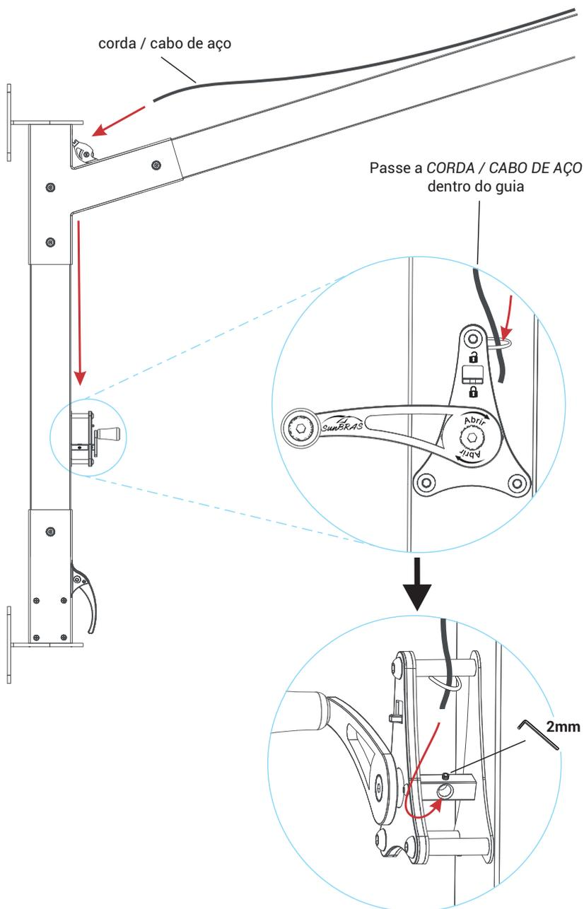
Após passar a CORDA / CABO DE AÇO no eixo, utilize a chave ALLEN 2mm para fazer o aperto do parafuso.
